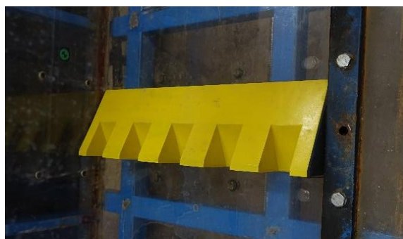
Слика 4. Низводни, назубљени праг умирујућег базена.
