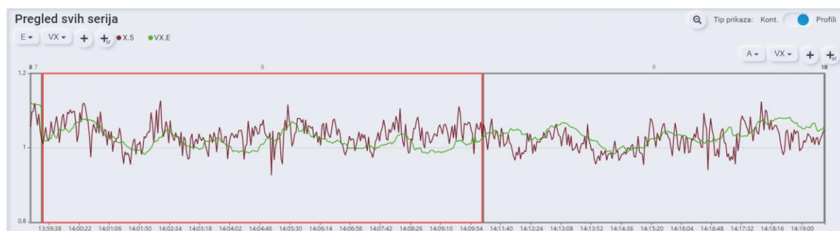
Slika 15. Poređenje podužne brzine merene EM sondom i ADV sondom.
