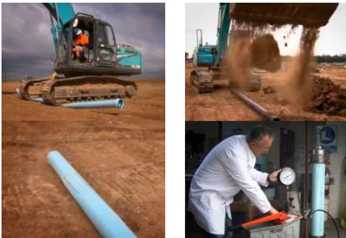
Slika 15. Testiranje PVC-O cevi na mehanička oštećenja
