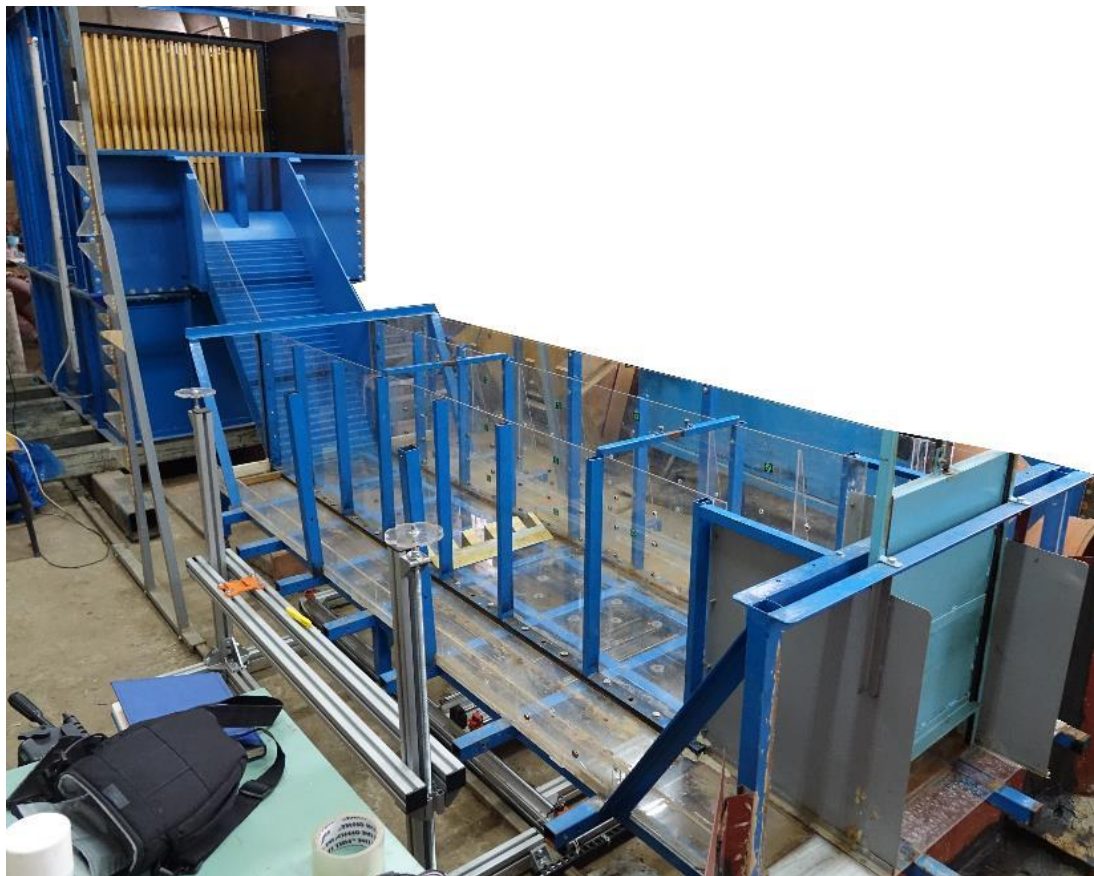
Слика 3. Фотографија парцијалног модела бране Сиди Насер, у размери 1:33.
