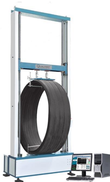
Slika 10. Izgled aparature za testiranja obodne krutosti SN
