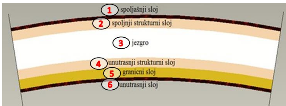
Slika 1. Tipiski strukturni presek GRP cevi
